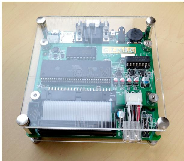
16.段付き手回しネジとポリカワッシャ(小)を使ってアクリルパネルを固定します。
