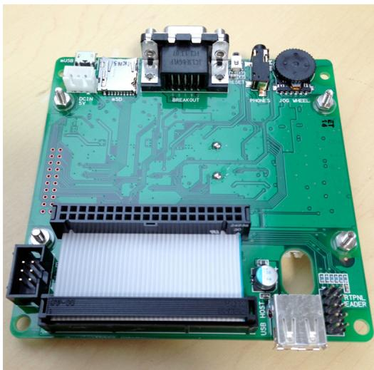
6.アナログケーブルを基板の穴に通し、基板裏面のコネクタにはめ込みます。
